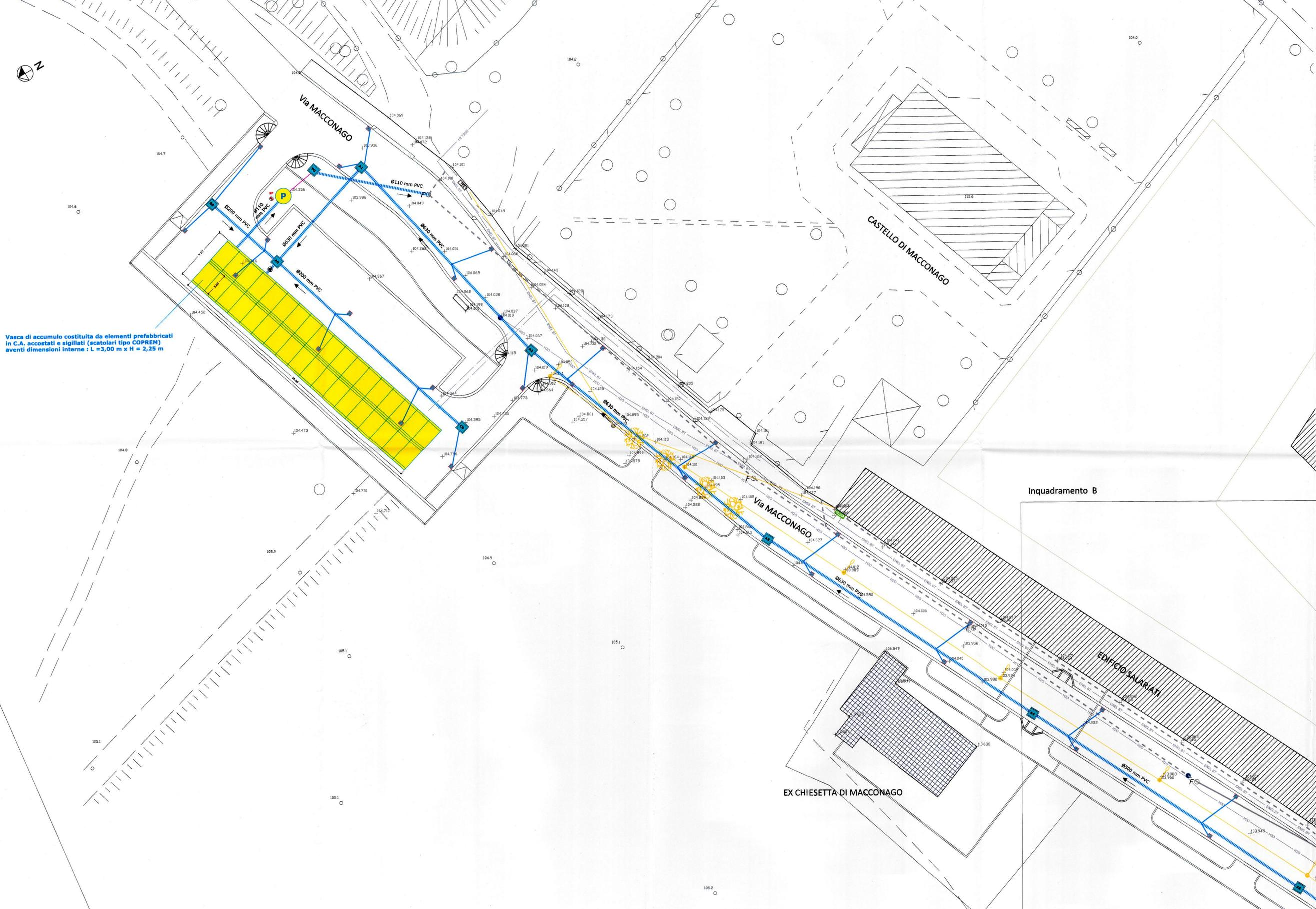
Vasca di accumulo costituita da elementi prefabbricati in C.A. accostati e sigillati (scatolari tipo COPREM) aventi dimensioni interne : L = 3,00 m x H = 2,25 m
