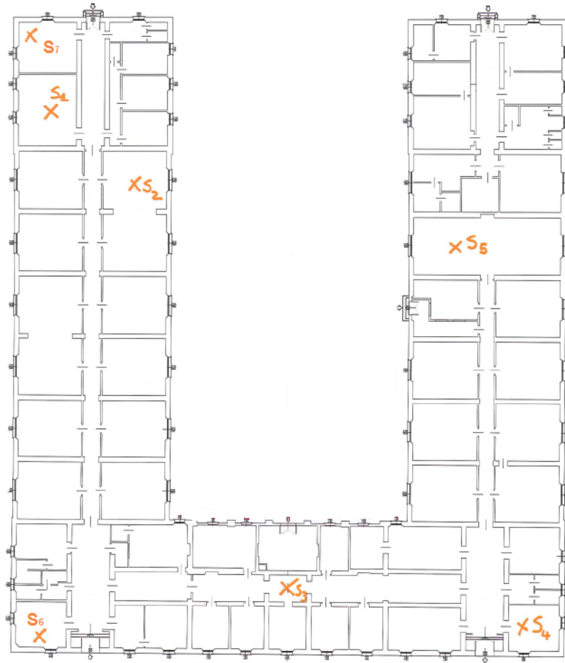
Figura 14 – Localizzazione delle indagini sui solai (S1÷S5 indagini al piano primo, S6, S7 indagini al piano terra)
