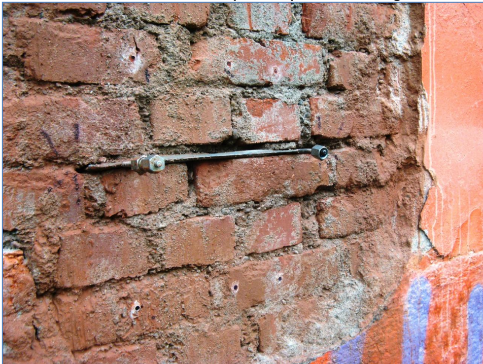
Il martinetto piatto singolo già in posizione
